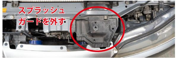
次に、右下写真赤丸部分のフロントバンパー下面の助手席側アンダーカバーを車体から取り外します。
